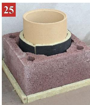
Kod prelaza preko međuspratne konstrukcije između armiranog betona i dimnjačkog plašta sa svake strane treba ostaviti 3 cm razmaka, što treba popuniti vatrostalnim materijalom. Ako imamo drvenu međuspratnu konstrukciju taj razmak iznosi 5 cm.
